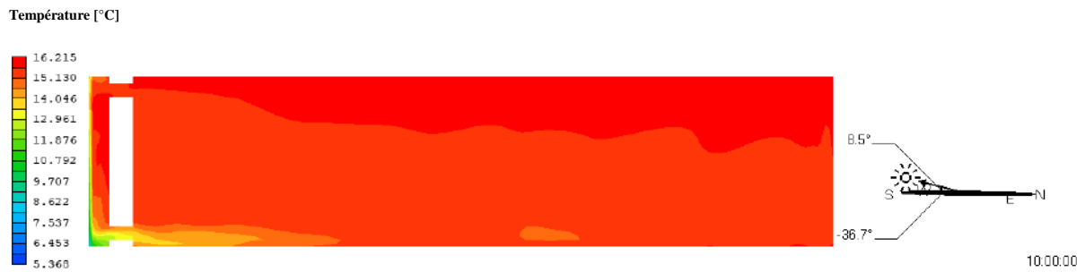
Figure II. 38 : Distribution horaire de la température dans la pièce à x = 0,42 m pour la Configuration 2.
