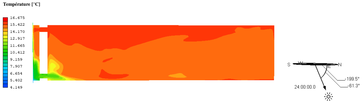
Figure II. 38 : Distribution horaire de la température dans la pièce à x = 0,42 m pour la Configuration 2.
