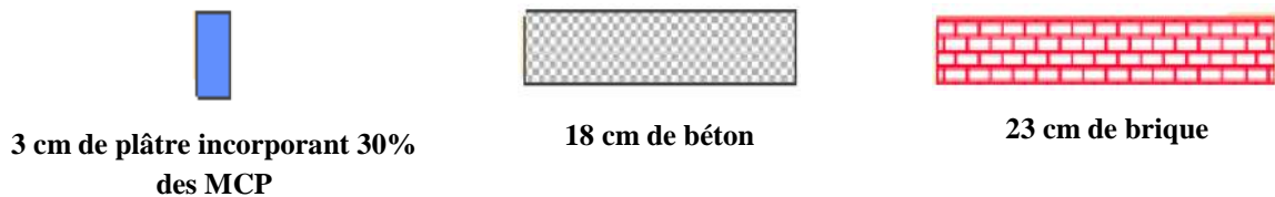
Figure I. 14 : Equivalence thermique de quelques parois de différentes épaisseurs en fonction de leurs matériaux [29].
